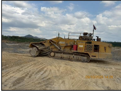
ภาพที่ 2.13 การใช้เครื่องจักร Surface Miner มาใช้ในการทำเหมือง
