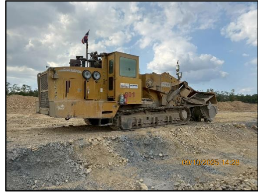
ภาพที่ 2.13 การใช้เครื่องจักร Surface Miner มาใช้ในการทำเหมือง
